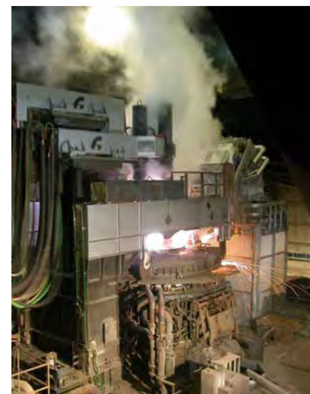
E-Ofen im Betrieb: Das Einschmelzen
