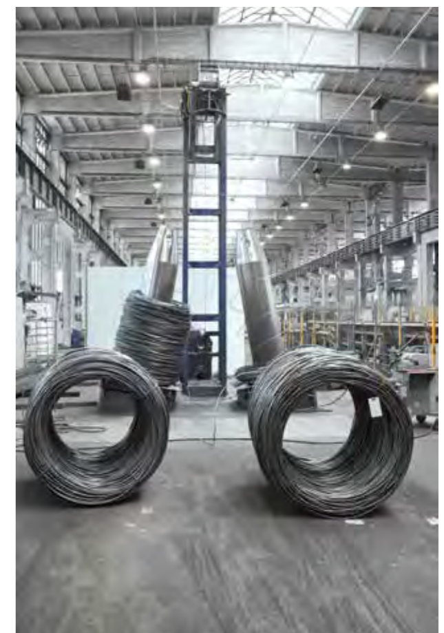
Walzdrahtablauf an den TEUREMA-Reckanlagen
