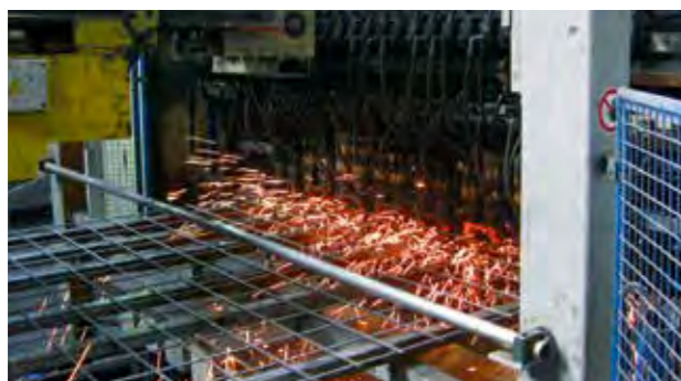
Automatische Mattenschweißmaschine im Betrieb
