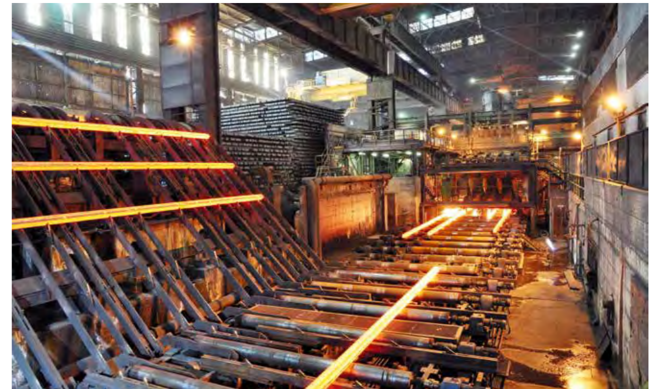
Die Stranggussanlage im Betrieb
