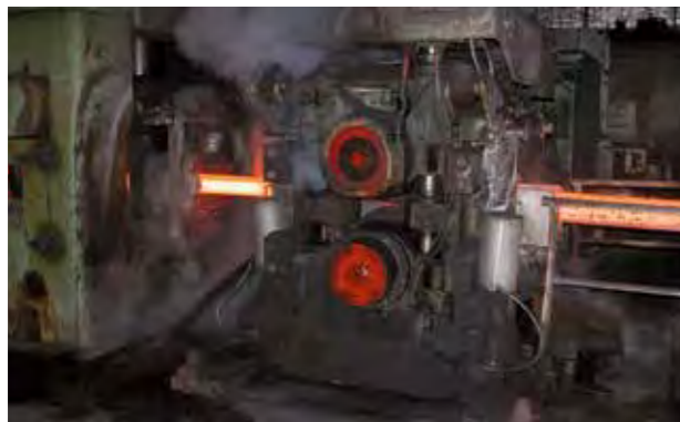
Walzgerüst der Vorstraße im Warmwalzwerk
