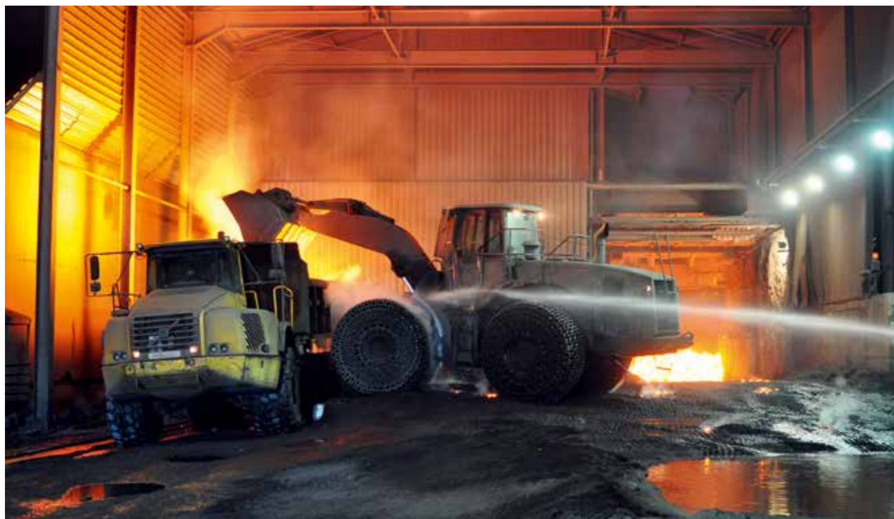
Schlackenmanagement E-Ofen-Schlacke in der Stahlwerkshalle
