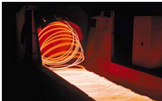
Funktionsweise des Warmwalzwerkes, hier: Drahtproduktion
