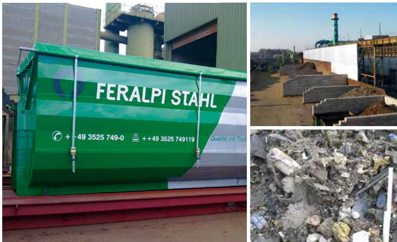
Lagerbereiche Kondirator, neues geschlossenes Containersystem für Schredderleichtfraktion (SLF)
