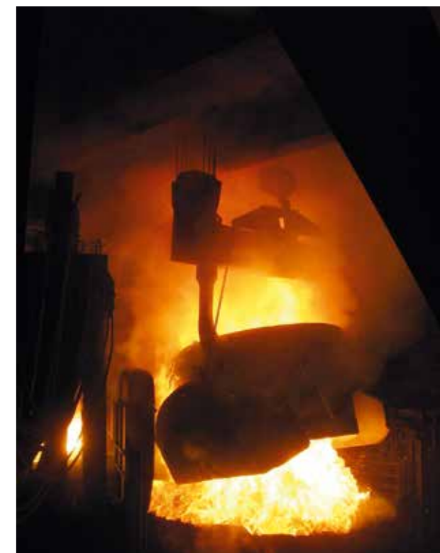
E-Ofen im Betrieb: Das Chargieren
